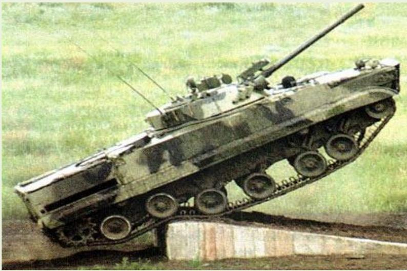
**БМП-3** – сочетание необычной для такой техники огневой мощи, подвижности и высокой проходимости на поле боя, хорошей броневой защиты, способности с ходу преодолеть водные преграды, оснащённости системой противорадиационной защиты, приборами и прицелами ночного видения делает эту машину эффективным средством достижения победы
