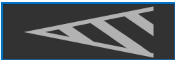
Разметка обозначает направляющие островки в местах разделения или слияния транспортных потоков.
