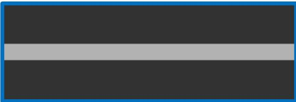
**Разметка разделяет транспортные потоки противоположных или попутных направлений на участках дорог, где перестроение разрешено только из одной полосы.**
