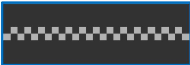
Разметка обозначает искусственную неровность на проезжей части.
