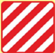
**Крупногабаритный груз** — в виде щитка размером 400 х 400 мм с нанесенными по диагонали красными и белыми чередующимися полосами шириной 50 мм со световозвращающей поверхностью.
