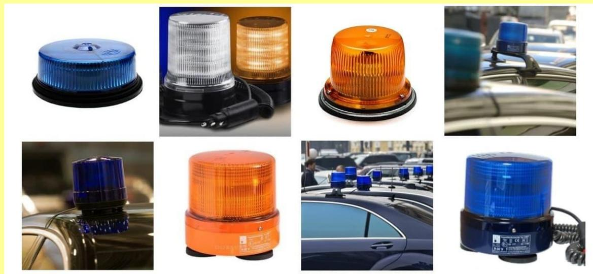
Предупреждающие сигналы янтарного цвета можно заметить на всех медленных автомобилях: автокранах, экскаваторах, тракторах и даже на скутерах в определенных условиях.
