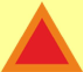
**Тихоходное транспортное средство** — в виде равностороннего треугольника с флюоресцирующим покрытием красного цвета и со световозвращающей каймой желтого или красного цвета (длина стороны треугольника от 350 до 365 мм, ширина каймы от 45 до 48 мм) — сзади механических транспортных средств, для которых предприятием-изготовителем установлена максимальная скорость не более 30 км/ч.
